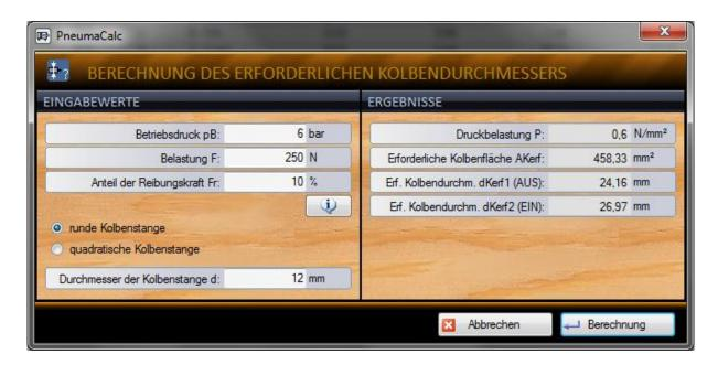
MIT DIESEM TOOL ERMITTELN SIE BEI BEDARF DEN ERFORDERLICHEN KOLBENDURCHMESSER FÜR DOPPELTWIRKENDE PNEUMATIK-ZYLINDER, JEWEILS FÜR DAS AUS- UND EINFAHREN. ZUR BERECHNUNG WERDEN DIE AUFTRETENDE BELASTUNG UND ANGABEN ZUR AUSFÜHRUNG DER KOLBENSTANGE BENÖTIGT.
