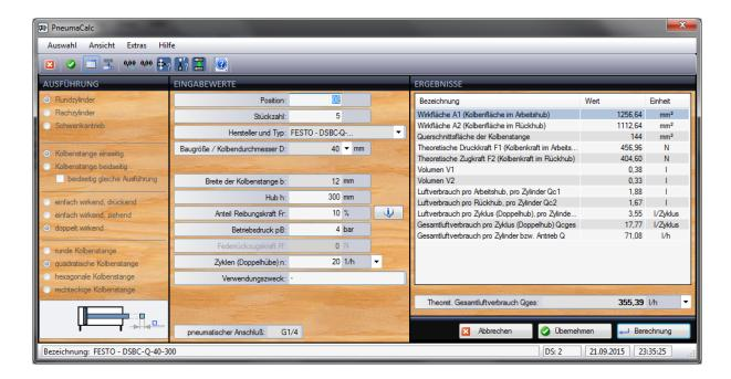
FÜR DIE AUSWAHL DER ZYLINDER (PNEUMATISCHE ANTRIEBE) KÖNNEN SIE AUF EINE UMFANGREICHE DATENBANK ZURÜCKGREIFEN, IN WELCHER BEREITS VIELE ANGABEN ZU ABMESSUNGEN UND AUSFÜHRUNGEN HINTERLEGT SIND. AUF WUNSCH KÖNNEN SIE JEDOCH AUCH ALLE DATEN BENUTZERDEFINIERT EINGEBEN.
