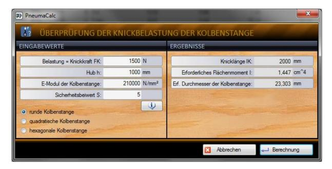
MIT DIESEM TOOL ÜBERPRÜFEN SIE DIE KNICKBELASTUNG DER KOLBENSTANGE. DABEI HABEN SIE DIE WAHL ZWISCHEN 3 VERSCHIEDENEN FORMEN DES KOLBENSTANGENQUERSCHNITTS.
